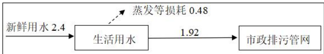
图 4-1 项目水平衡图
